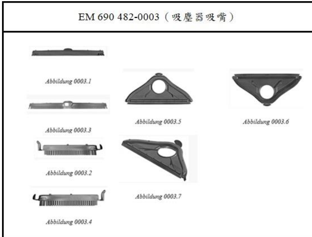
圖 4 系爭註冊設計「吸塵器吸嘴之移轉板」的所有圖式
